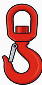
Rysunek 20 Zabrania się obracania ładunkiem zawieszonym na haku obrotowym wyposażonym w łożysko ślizgowe
