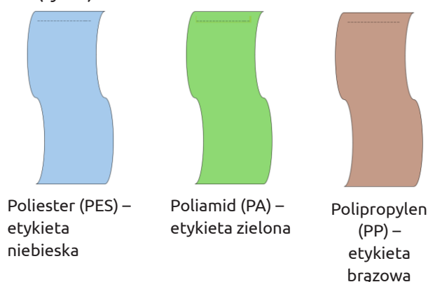
Rysunek 2 Barwy etykiety wskazujące materiał zawiesia
