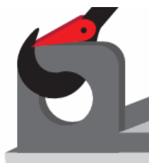
Rysunek 16 Prawidłowy sposób założenia haka
