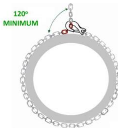
Rysunek 10 Sposób zaczepienia haka o ciągnio przy obwiązywaniu ładunków
