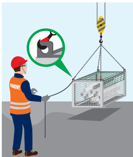
Rysunek 9 Sposób zaczepienia haków zawiesi
