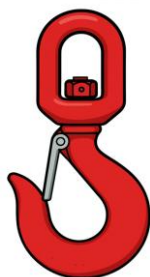
Rysunek 20 Zabrania się obracania ładunkiem zawieszonym na haku obrotowym wyposażonym w łożysko ślizgowe
