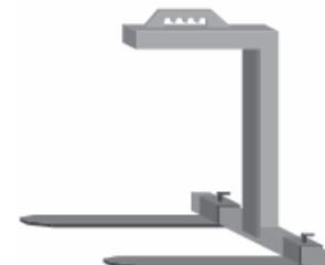
Rysunek 18 Uchwyty specjalne do transportu: a) dwuteowników, b) kręgów, c) materiałów na paletach
