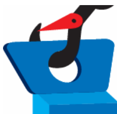
Rysunek 16 Prawidłowy sposób założenia haka
